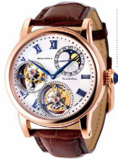
海鸥表ST8083GA玫瑰金日历月相双陀飞轮腕表 海鸥表ST8083GA采用ST8083同轴和偏心两种结构的陀飞轮机芯，并使用差动结构联接两组陀飞轮，使得两组陀飞轮既能独立运转又能互动共振，达到走时精度和工艺美学的完美平衡。这个结构已经在2008年巴塞尔国际钟表展上凭借自主知识产权通过了“严峻考验”，向世界证明了中国制表的最高水平。
