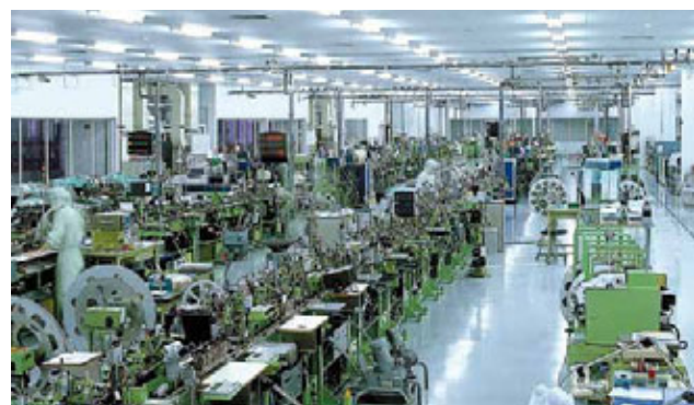
SII石英机芯全自动生产线（日本/新加坡）
